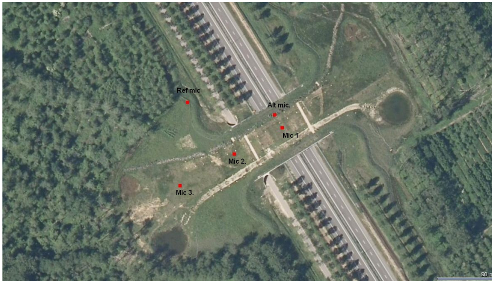
Figuur 4: Schematische weergave meetpunten op het ecoduct Het Groene Woud.
